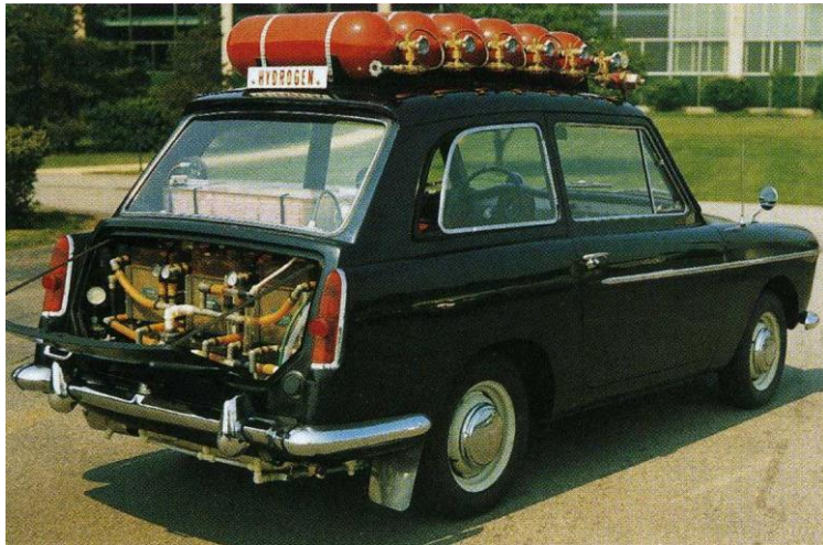
Hybrydowy samochód z ogniwem paliwowym Austin A40 zbudowany przez Karla Kordescha (Austria) w 1970.
